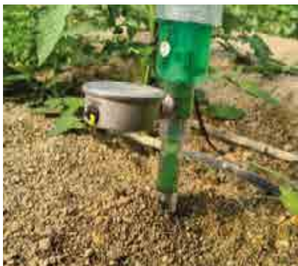
▼ Sensor de potencial hídrico del suelo
